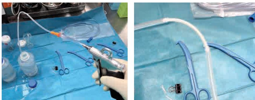
**Abb. 5 a, b:** Beprobung der Druckluft mit einem zwischengesteckten, bewusst kontaminierten Schlauch.
